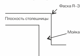
Рис.2 Приклейка мойки AMULET в ровень со столешницей БЕСШОВНЫЙ
